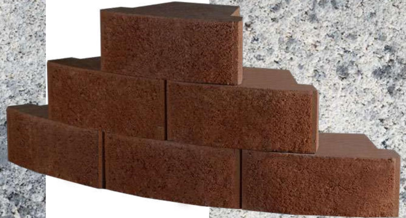
Bloques prefabricados de hormigón con los que crear muros de contención verticales de hasta seis metros de altura, equipados con unos tetones en su parte inferior que evitan el desplazamiento de una pieza respecto a otras, junto con el suministro de la geomalla adecuada posibilitamos el armado del talud. Esta tipología permite curvaturas positivas y negativas de hasta 1,5m de radio en planta. Consúltenos para ampliar información.
